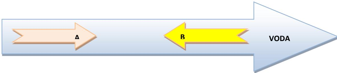
Kako se medij (voda) giba brzinom  $v_V$ , a brzine podmornica A i B dane su u odnosu na tlo, potrebno je izračunati relativne brzine podmornica u odnosu na medij kojim se prenosi zvuk
